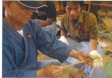
ベテラン指導者から、うちわ竹骨に切り込みを入れる作業から教わります
