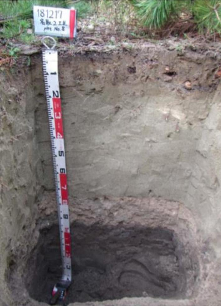
**断面**：仙台森林管理署管内 名取2工区 plot No.8 付近 1m (未熟土) 母材 購入土 (山砂~75cm、山土 75~95cm) + 地山 (海砂) 調査地 宮城県名取市 林野庁直轄 海岸防災林造成工事施工地 (仙台森林管理署管内) (施工者：? 建設) 図幅 1:25,000 仙台空港 緯度 38° 9'5"N 経度 140° 56'52"E 標高 4 m 地形 宮城県名取市市有海岸防災林生育基盤盛土上 断面方位 335° N 傾斜 1° 有効土壌深 95+ cm (95cm 以深は地山) 林相 クロマツ植栽地 (H26年4月植栽)
