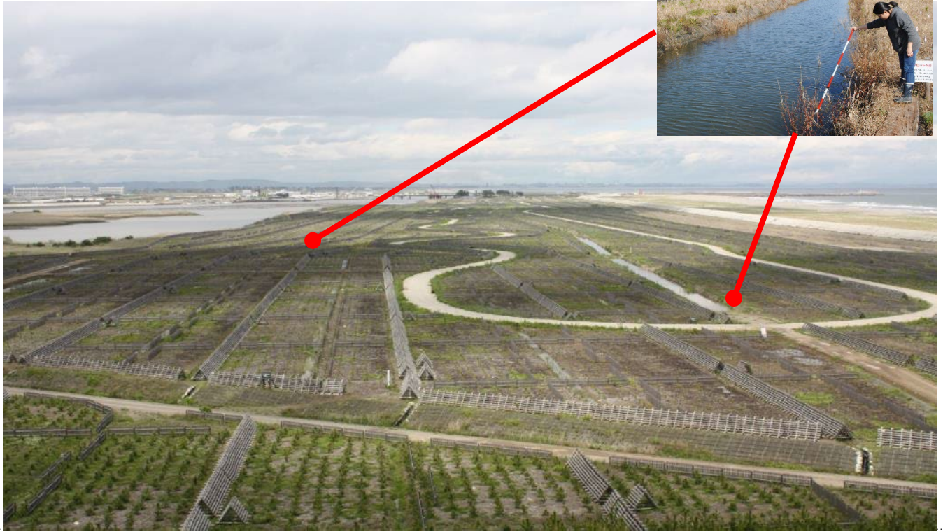
名取市海岸林中央部から北の多湿地帯全景。凝灰岩質砂岩の盛土土壌、瓦礫仮置場としての転圧、サイクリング道工事による排水抑止、ヘドロ混入などの影響も加わり多湿箇所が非常に多い
