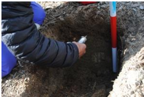
写真-4 硬度計による調査
